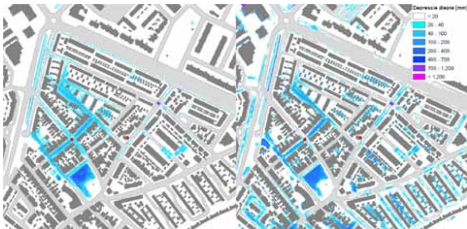
Afbeelding 7: Waterdieptes rond de Zandvoortsestraat en omgeving, bepaald met een 1D/2D-model (links) en een stationaire maaiveldanalyse (rechts). Met een rode stip zijn bekende knelpuntlocaties aangegeven.
