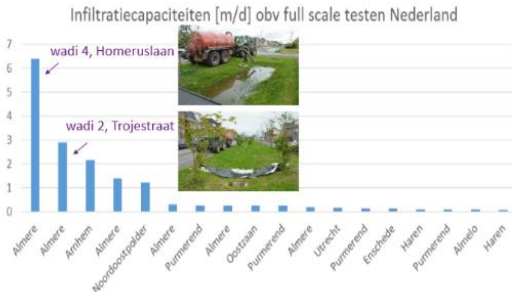
Afbeelding 3. Onderzoekresultaten full scale test bij wadi's in Almere vergeleken met onderzoek in andere gemeenten.
