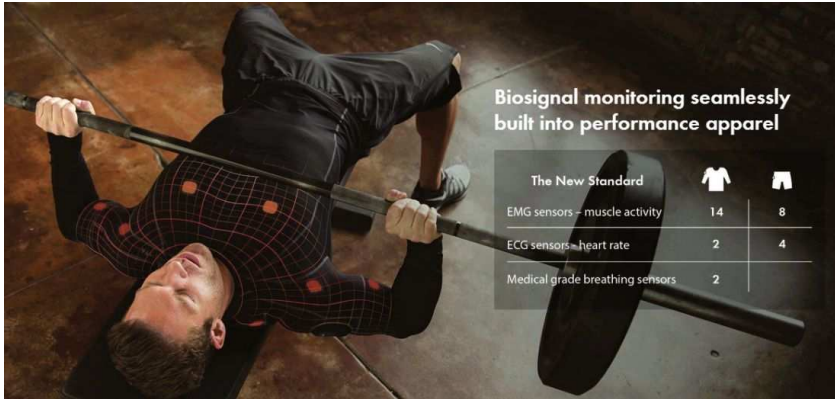
Figuur 10 Visualisatie van een concept voor meting van ECG en EMG in kleding (www.liveathos.com)
