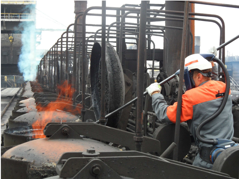
Figuur 14 Werknemer bij Tata-steel uitgerust met het Prospie-systeem (www.prospie.eu) dat CO/CO 2 meet op de rug van het pak
