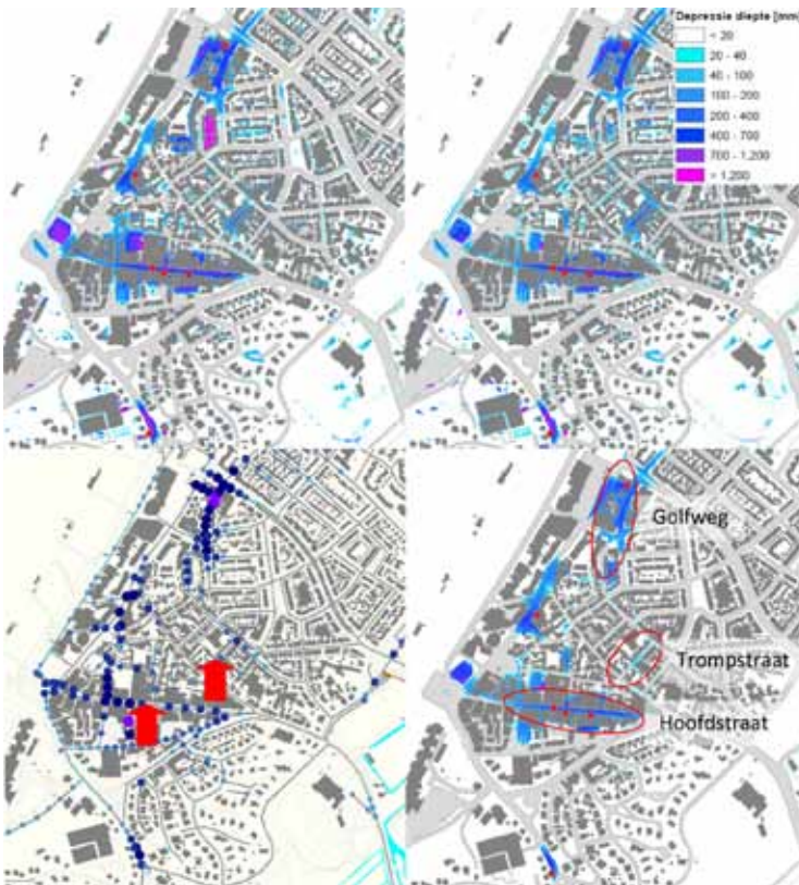
Afbeelding 3: Waterdieptes voor Noordwijk aan Zee, bepaald met een stationaire maai-veldanalyse (linksboven), een dynamische maai-veldanalyse (rechtsboven), een gekoppeld 1D/1D-model (linksonder) en een gekoppeld 1D/2D-model (rechtsonder). Met een rode stip zijn bekende knelpuntlocaties aangegeven en de pijlen geven de locatie aan van een verkeerde putdekselhoogte in het 1D/1D-model.
