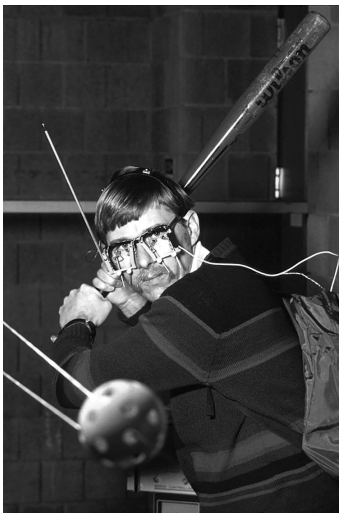
Figuur 3 Kijkgedragapparatuur: links in 1984 in het lab met een bal, bewegend over draden (met toestemming overgenomen uit Bahill & Laritz, 1984) en rechts anno 2016 op het basketbalveld tijdens het schieten
