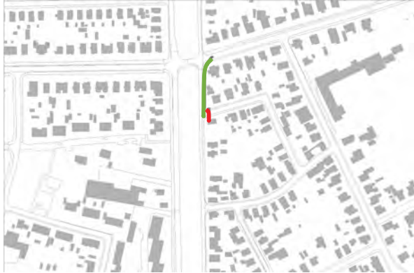
Figuur 6. In rood een drempel en in groen een greppel om de waterstroming te sturen
