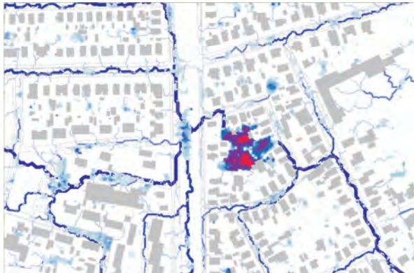
Figuur 5. Deze figuur laat zien of er bij een extreme bui veel of weinig water in een depressie (lokale laagte) kan blijven staan. Lichtblauw is weinig water, paars is veel. Daarnaast toont deze figuur met stroombanen hoe het water van links naar rechts stroomt, de depressie tussen de woningen vult en doorstroomt.
