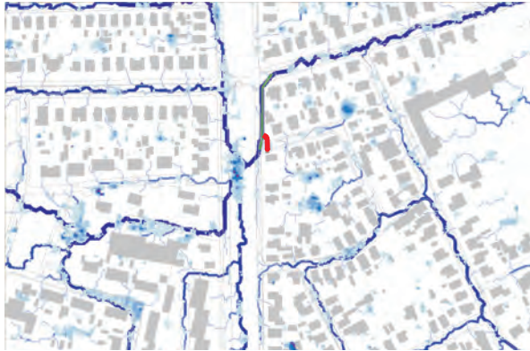
Figuur 7. De stroombanen in de nieuwe situatie. Het water stroomt niet meer naar de laagte tussen de woningen.
